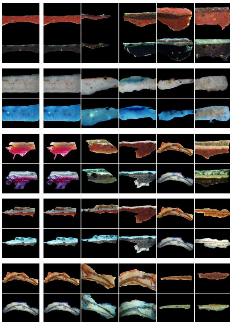
Obrázek 5.3: Příklady výsledků obrazového vyhledávání v Nephele. V levém sloupci jsou dvojice snímků v bílém a UV světle, které byly systému kladeny jako dotaz. V odpovídajících řádcích jsou seřazeny výsledky hledání podle podobnosti. První sloupec ve výsledcích je identický dotazu (jsou to nejpodobnější snímky).
